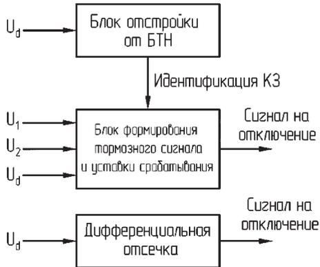
Рис. 2 Структурная схема дифференциальной защиты на поясах Роговского
