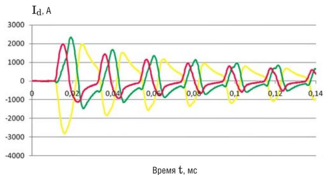
Рис. 5 Осциллограмма дифференциальных токов при БТН (токи приведены к стороне низшего напряжения)
